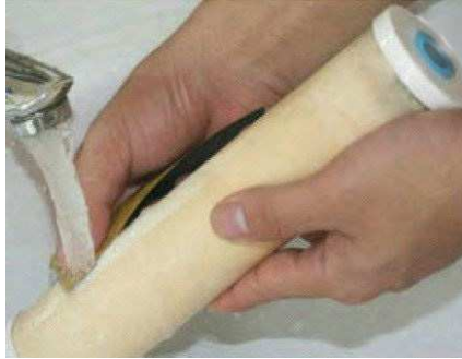
(شكل رقم ١٠) عملية غسل وتنظيف شمعة الفلتر المقترحة
