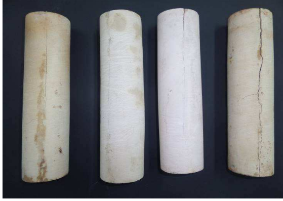
(شكل رقم ٧) عينات من نماذج الفلتر المقترح المنفذة بتقنية الضغط
