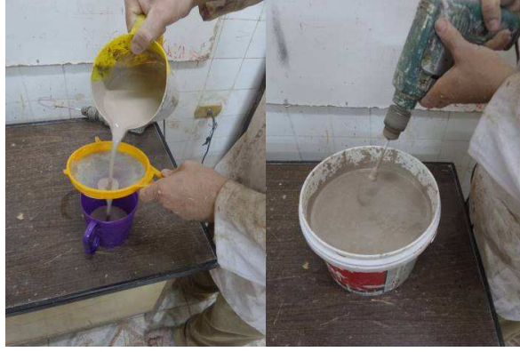
(شكل رقم ٤) تجهيز طين وخلط طين الصب السائل وتصفيته
