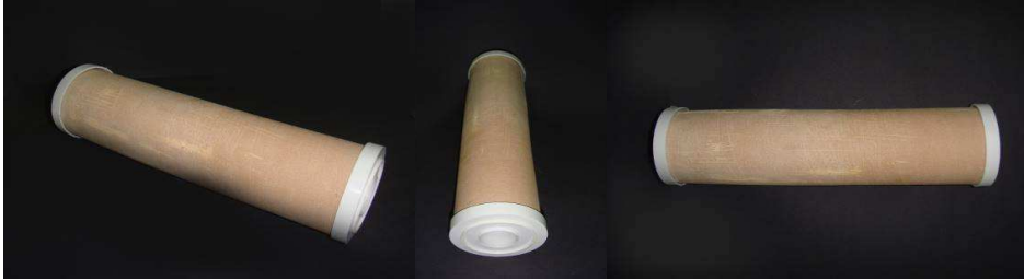
(شكل رقم ٨) تجهيز النموذج النهائي لشمعة الفلتر المقترح للتركيب في جهاز الترشيح
