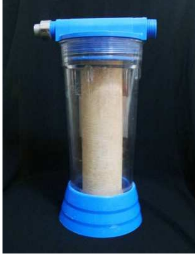
(شكل رقم ٩) النموذج النهائي لشمعة الفلتر المقترح مثبتة داخل جهاز ترشيح جاهز الصنع
