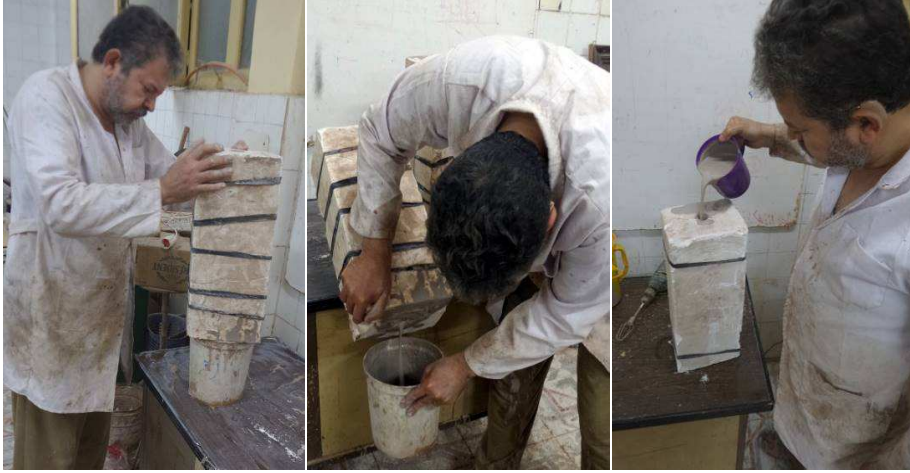
(شكل رقم ٥) صب الطين السائل وتفريغه
